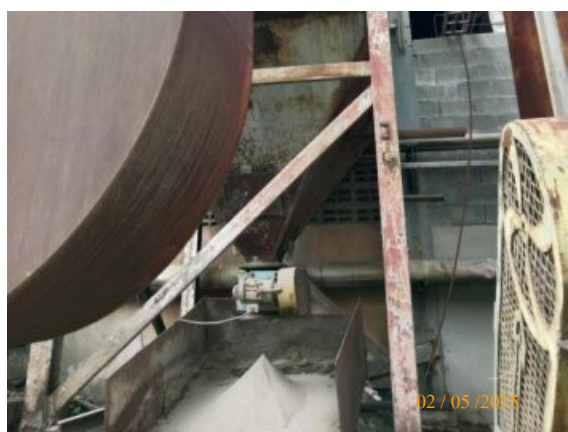
รูปที่ 2-24 ภาพขณะรองรับผงฝุ่นจากการบำบัดด้วย Cyclone
